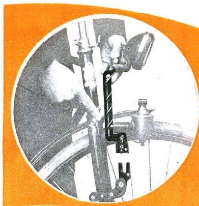
Genom ett enkelt grepp avtages hållaren med lykta och generator.
