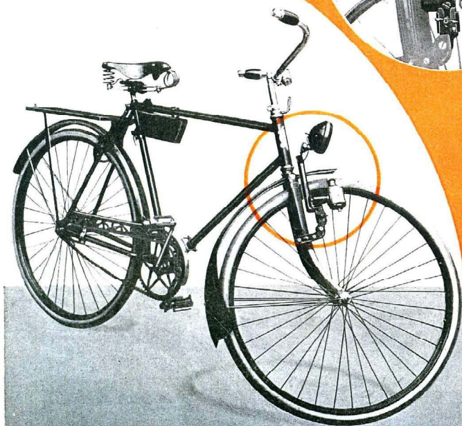
Genom ett enkelt grepp avtages hållaren med lykta och generator.
