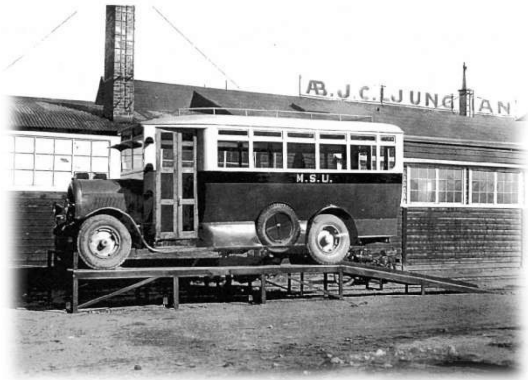
Test av serviceramp för större fordon, Citadellskajen
