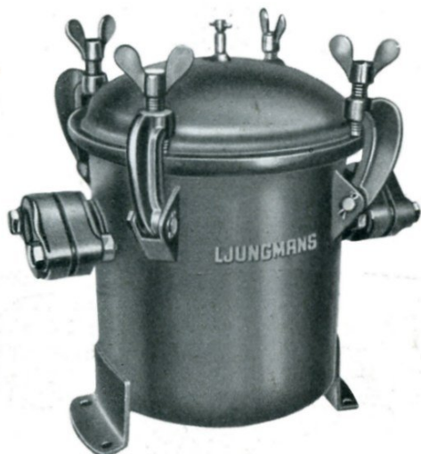
BENSINFILTER med sämskskinnsinlägg. Den uttag-bara filterinsatsen består av filterskivor av perforerad plåt med inlägg av sämskskinn och finmaskig metall-trådsduk, som äro centralt inspända mellan tallrikar av lättmetall. Normalutförande med ovalflänsar och motflänsar för 2" rördimension.
