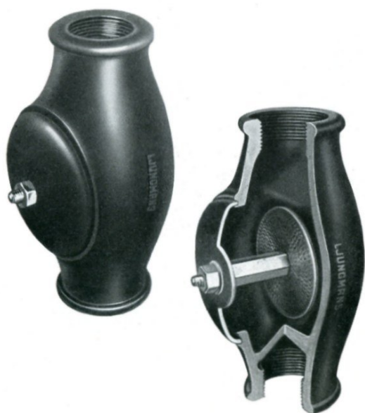
INSPEKTIONSBOX med kapillärpatron av nysilver eller aluminium, hus av gjutjärn. Anslutningsmuffar 1 1/4" rörgänga.
