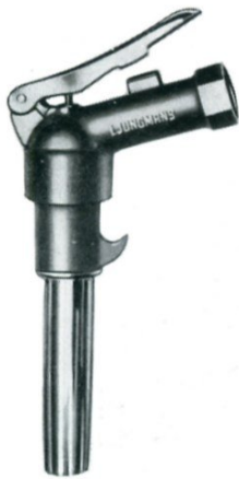
AVTAPPNINGSVENTIL för Vici, Tor m. fl. mätare. Ventilhus i lättmetall, inbyggd hake i handtag. Anslutning 1" rörgänga.
