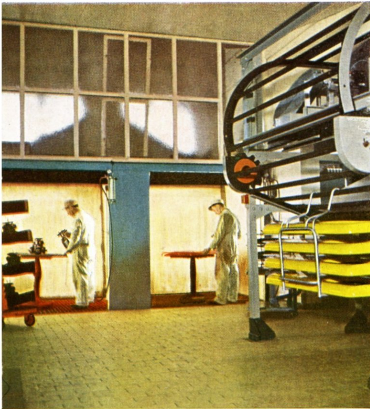
Sprutmålarna har god plats i de med vattenridåer försedda boxarna.
