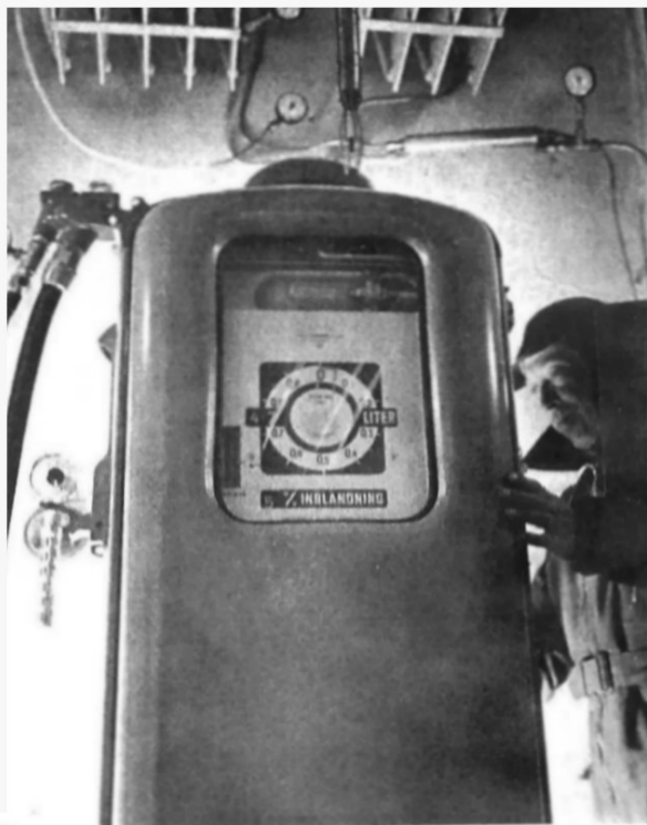
Prov med Star-Mix mätapparat i frys- och tropikrum. I detta kan såväl mätare som andra apparater provköras i temperaturer från +50^{\circ}\text{C} ned till -30^{\circ}\text{C} .
