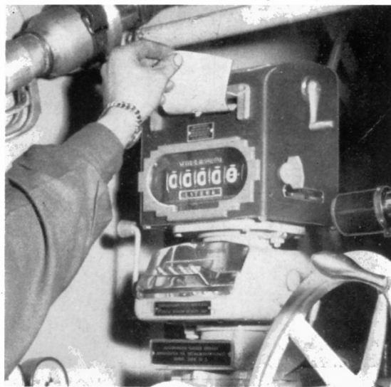
Genomströmningsmätaren, av typ 3"/3 Real, är försedd med både förinställningsanordning och kvittostämpningsräkneverk, varigenom god kontroll erhålles på utlämnade kvantiteter drivmedel.
