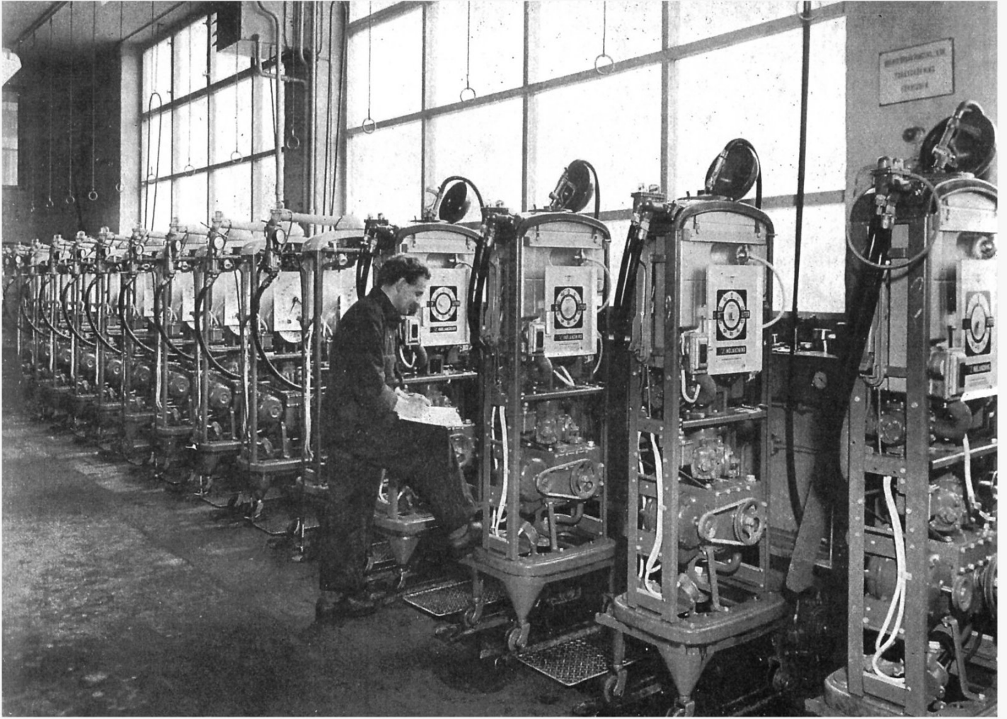
Slutlig inkörning samt justering och kröning äger rum i provningsanläggning.
