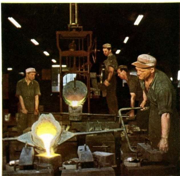
Gjutning av handformat gråjärnsgods
