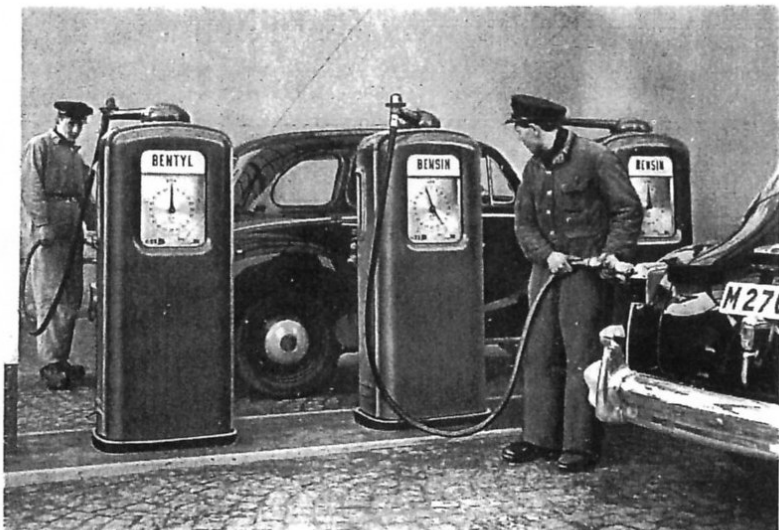
Nya STAR-mätaren med svängarm på servicestation. Tack vare svängarmen betjänas bilisten bekvämt på båda sidor om refugen.
