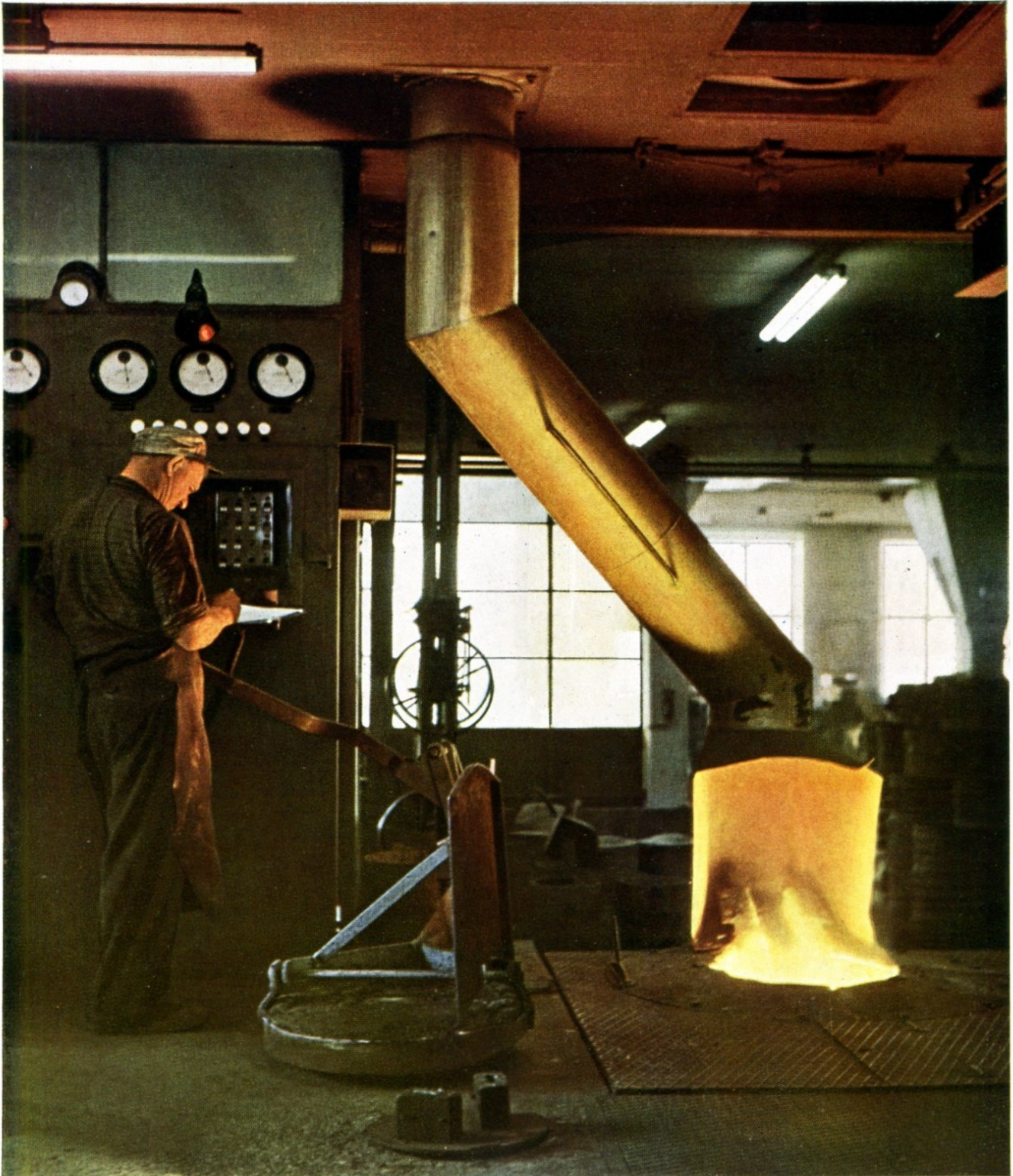
Smältning av gråjärn i högfrekvensugn
