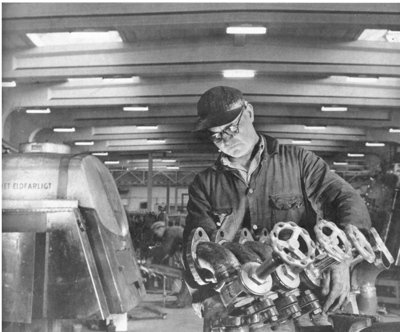
Montering av rörsystem till mätareskåp på biltank. Nedan till höger: montering av biltankar.
