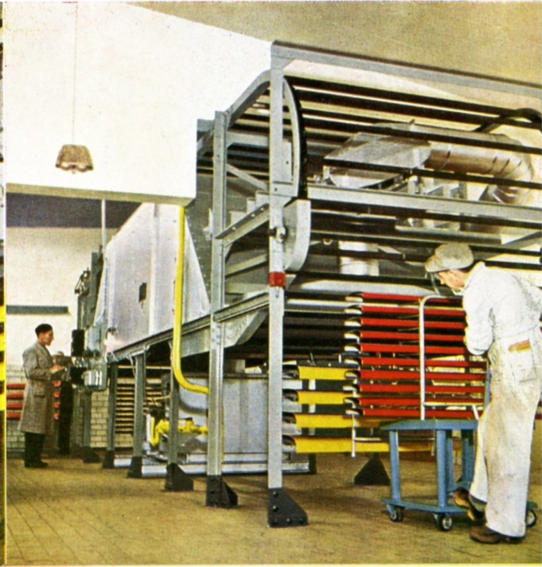
De färdigsprutade detaljerna inhängas på Ballard-ugnens conveyor.
