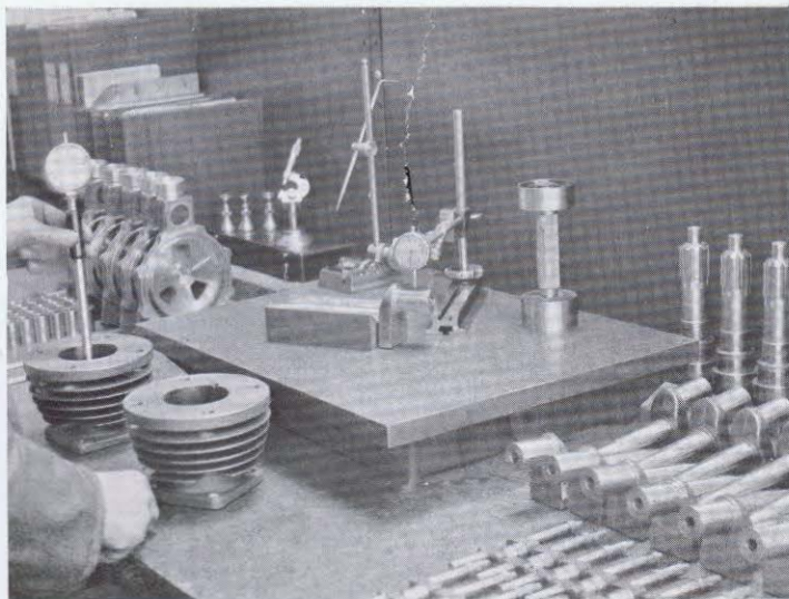
Kontroll. — Här genomgår produkten de fastställda toleransernas skärseid.
